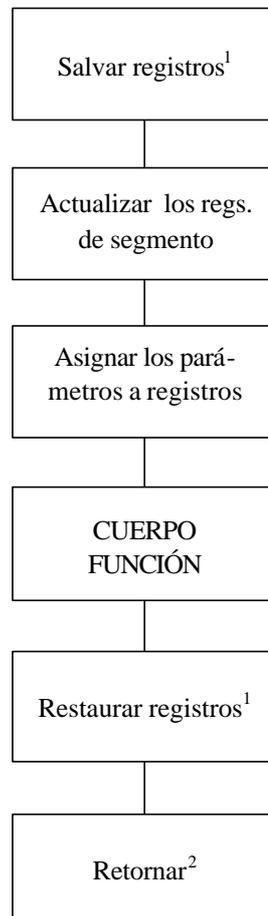
(<sup>1</sup>) Los únicos registros que se salvan y restauran de la pila si se van a utilizar, son ebx, esi, edi, esp, los registros de segmento (CS, DS, ES) y el bit de dirección del registro de flags. El registro EIP siempre es guardado en la pila por la instrucción CALL que llama la función en cuestión.
